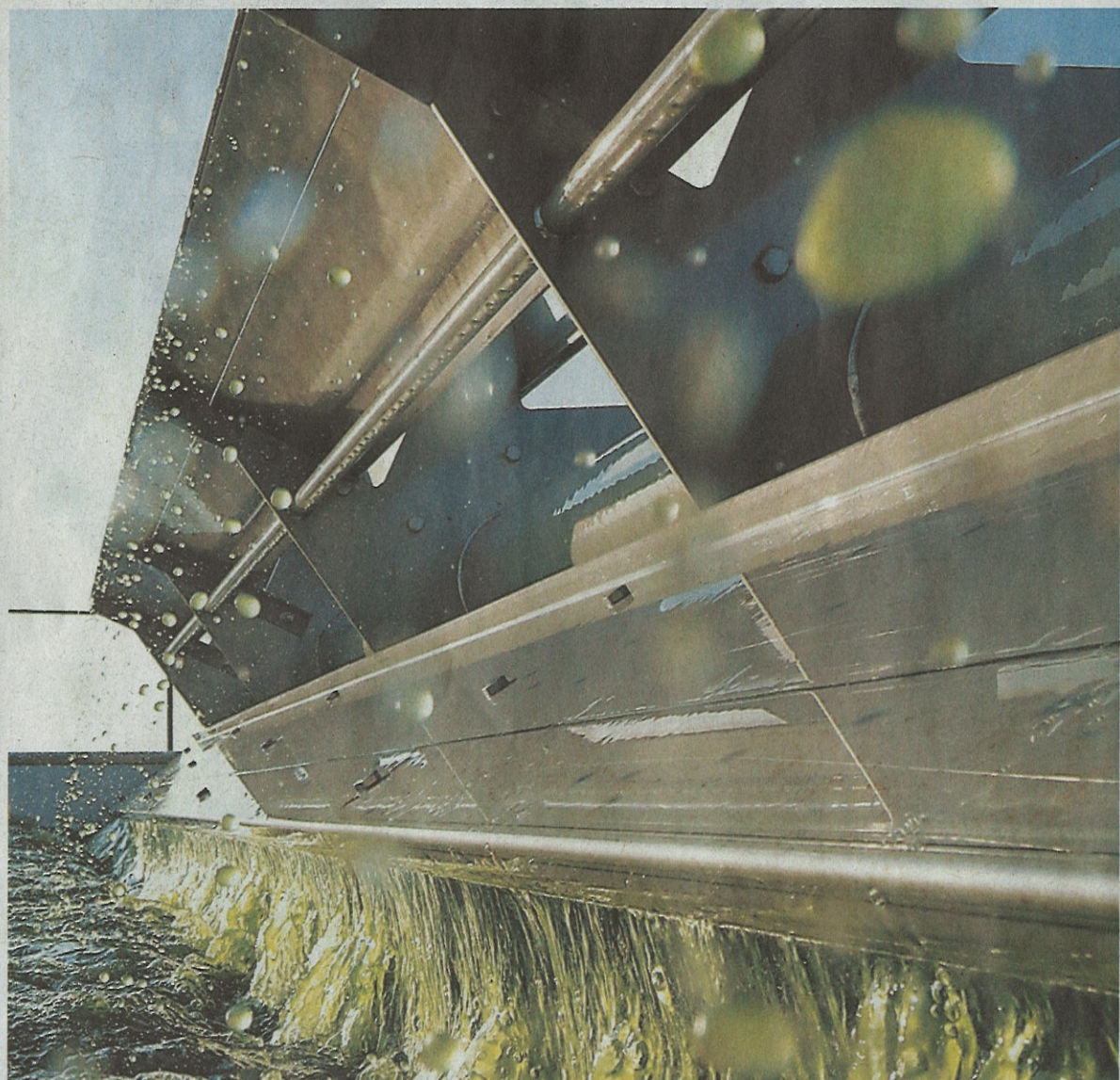
油を生み出す藻類の培養池。水車が回転して光合成を促進する(宮城県石巻市)
